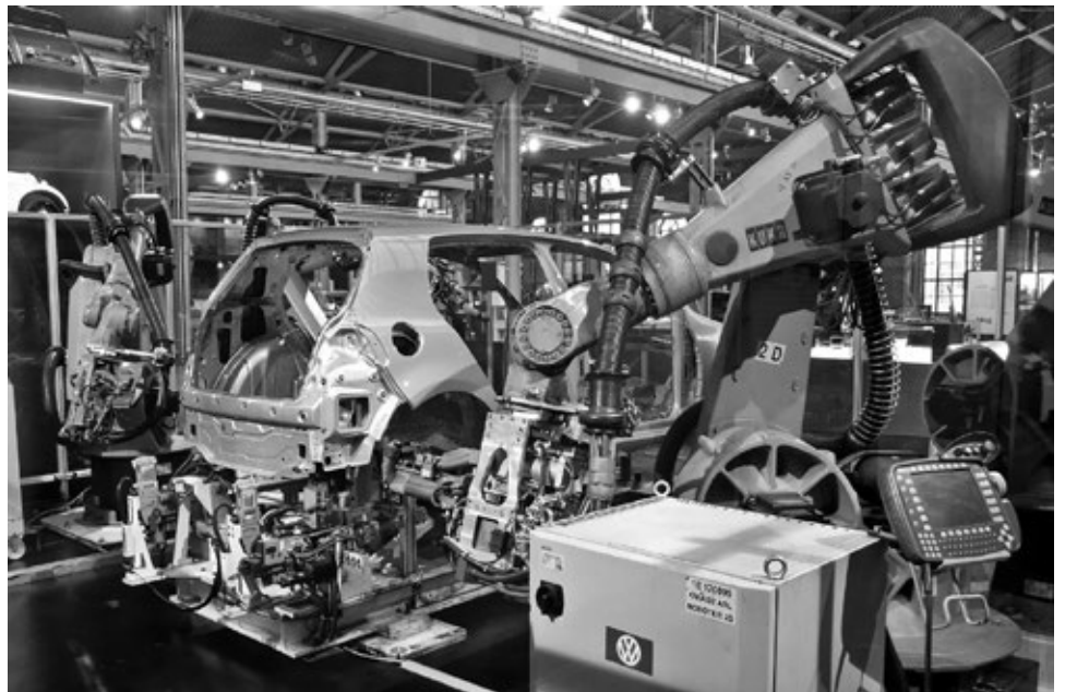
Letzte Ursache gesellschaftlicher Veränderungen sind Änderungen in der Produktions- und Austauschweise: Roboter einer Karosserieschweißanlage im Industriemuseum Chemnitz
